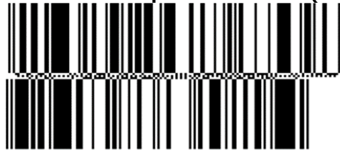
GS1 DataBar Expanded Stacked (Databar étendu empilé)
